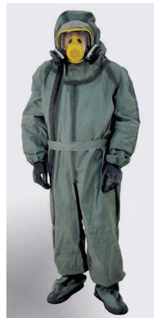
Рис. 8. Костюм КЗ-А (модель 2). Конструкция – комбинезон с гермомолнией. Защищает от радиоактивных веществ и растворов (при угрозе облива) при ожидаемых уровнях загрязнения до 1000 ДЗ, а также от внешнего бета-излучения при плотности потока бета-частиц до 10 ДПП<sub>перс</sub>.
