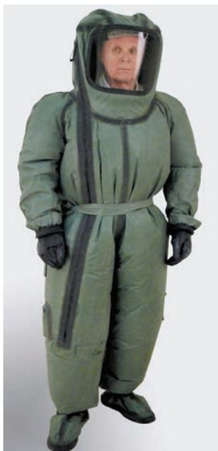
Рис. 7. Костюм КЗ-А (модель 1). Конструкция – комбинезон с гермомолнией, с панорамным стеклом. Защищает от радиоактивных веществ и растворов (при угрозе облива) при ожидаемых уровнях загрязнения до 1000 ДЗ, а также от внешнего бета-излучения при плотности потока бета-частиц до 10 ДПП<sub>перс</sub>.
