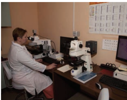
Рис. 2. Автоматизированная система «Метафер4» для автоматического поиска метафаз, карiotипирования и проведения FISH-исследований (фирма «МетаСистемс», Германия)
