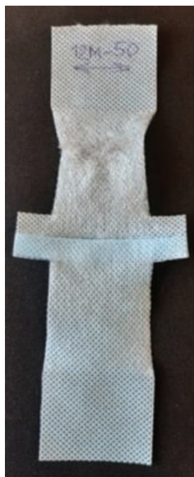
Рис. 7. Образец материала комбинезона производства ЭПМ (шифр 12М-00) после определения разрывной нагрузки шва в продольном направлении
