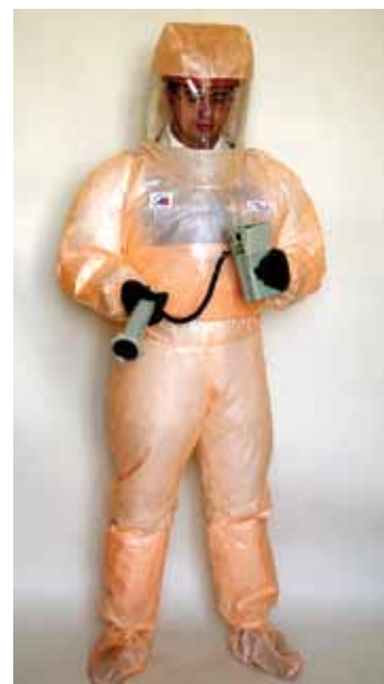
Рис. 6. Изолирующий костюм КЗ-П. Предназначен для использования в условиях загрязнения воздуха и поверх- ностей радиоактивными веществами. Изготовлен из нетканого полотна, ламинированного полиэтиленовой пленкой. При утилизации методом сжигания не выделяются агрессивные и опасные химические вещества. Используется в комплекте с автоном- ным источником воздухообеспечения типа «Нива-2М»
