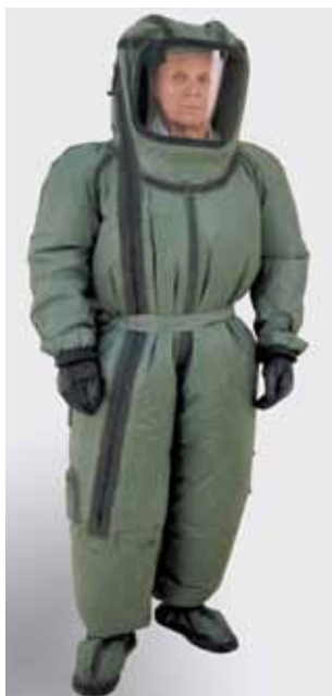
Рис. 7. Костюм КЗ-А (модель 1). Конструкция — комбинезон с гермомолнией, с панорамным стеклом. Защищает от радиоактивных веществ и растворов (при угрозе облива) при ожидаемых уровнях загрязнения до 1000 ДЗ, а также от внешнего бета-излучения при плотности потока бета-частиц до 10 ДПП перс . Используется в комплекте с автономным источником воздухообеспечения типа «Нива-2М», укомплектованным двумя противоаэрозольными фильтрами
