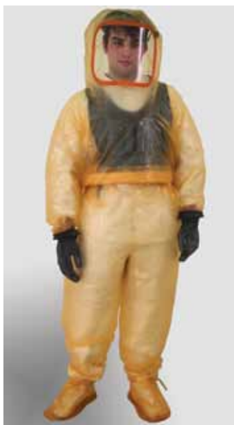
Рис. 5. Изолирующий костюм КЗ-У1 с панорамным стеклом. Предназначен для проведения ремонтных и аварий- но-восстановительных работ в усло- виях загрязнения воздуха и поверх- ности помещений радиоактивными и химически токсичными веществами. Изготовлен из легкодезаkтивируемого поливинилхлоридного пластиката. Используется в комплекте с автоном- ным источником воздухообеспечения типа «Нива-2М» с двумя противоаэро- зольными коробками или при подаче чистого воздуха от пневмолинии
