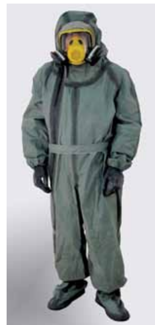
Рис. 8. Костюм КЗ-А (модель 2). Конструкция — комбинезон с гермомолнией. Защищает от радиоактивных веществ и растворов (при угрозе облива) при ожидаемых уровнях загрязнения до 1000 ДЗ, а также от внешнего бета-излучения при плотности потока бета-частиц до 10 ДПП перс . Используется в комплекте с промышленным противогазом с панорамной лицевой частью и высокоэффективными фильтрами, либо с изолирующим дыхательным аппаратом
