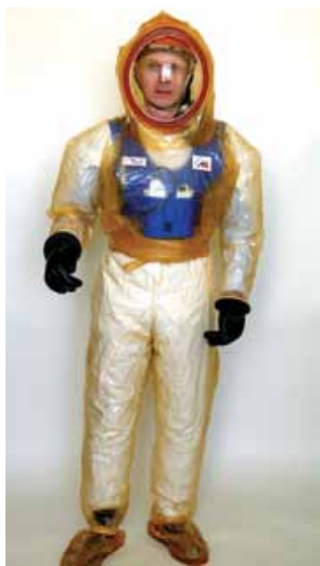
Рис. 4. Изолирующий костюм КЗ-У. Предназначен для проведения ремонт- ных и аварийно-восстановительных работ в условиях загрязнения воздуха и поверхности помещений радио- активными и химически токсичными веществами. Изготовлен из легкодеза- ктивируемого поливинилхлоридного пластиката. Используется в комплекте с автоном- ным источником воздухообеспечения типа «Нива-2М» или при подаче чи- стого воздуха от пневмолинии. Вместо бахил могут быть приварены сапоги
