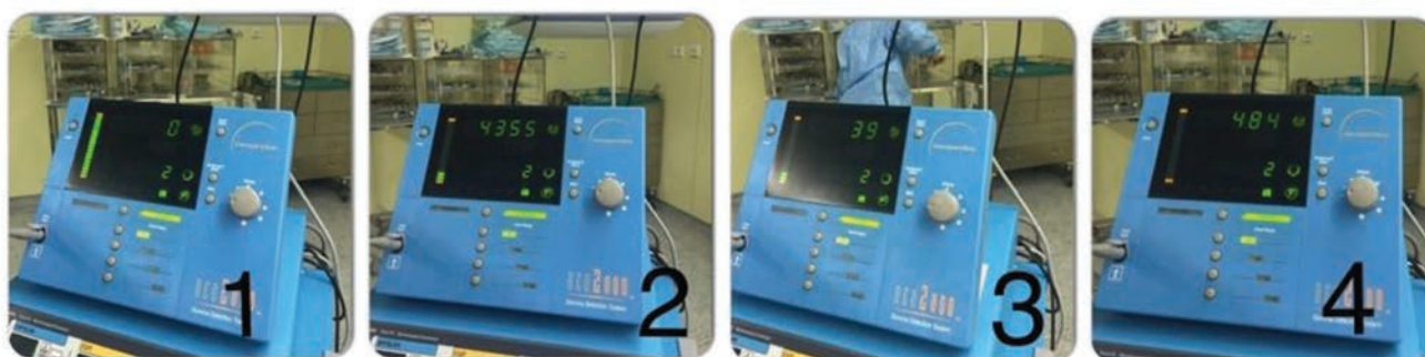
Рис. 3. Работа прибора NEO 2000 (Johnson&Johnson, США) для интраоперационного поиска СЛУ. Показатели дисплея: 1 – аппарат включен, установлен на 0; 2 – скорость счета импульсов от гамма-излучения из места введения РФП; 3 – фоновое излучение; 4 – скорость счета импульсов от гамма-излучения из СЛУ
