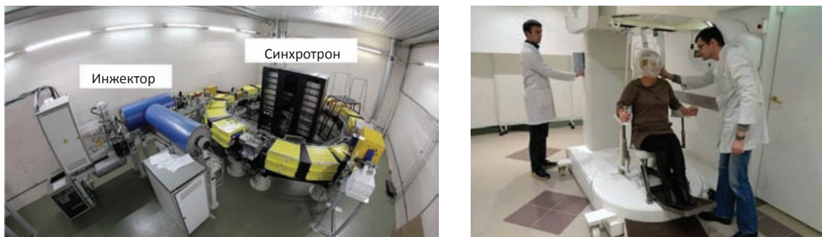
Рис. 6. Протонный синхротрон ФТЦ ФИАН им. Лебедева (поставляется ЗАО «Протом») (слева) и система иммобилизации пациентов для облучения областей головы и шеи в городской больнице, г. Протвино (справа)
