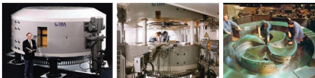
Рис. 7. Протонный циклотрон C-235 компании IBA. Слева направо: общий вид ускорителя, ускоритель в процессе сборки, спиральные полюса магнита
