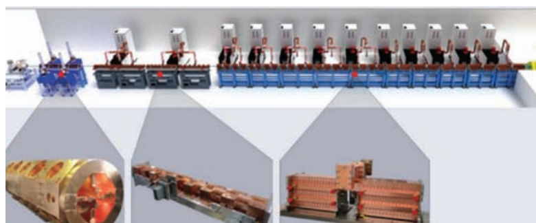
Рис. 14. Полноразмерный вид ускорителя LIGHT: используется три различных типа ВЧ структур: Radio Frequency Quadrupole (RFQ), 4 секции, Side Coupled Drift Tube Linac (SCDTL), 4 секции, и Cell Coupled Linac (CCL), 15 секций
