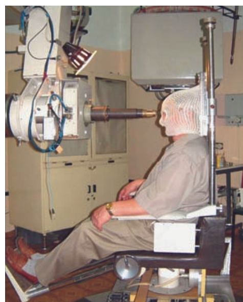
Рис. 3. Центр ПЛТ ИТЭФ. Облучение больного с опухолью орбиты в положении сидя на горизонтальном мононаправленном пучке
