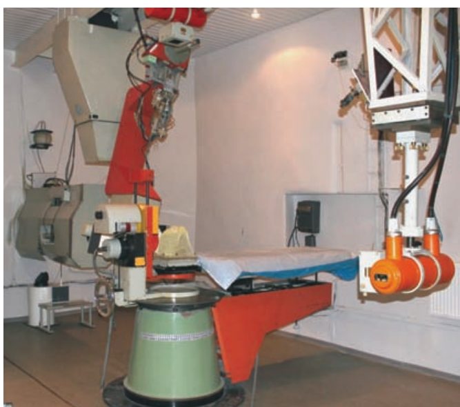
Рис. 2. Центр ПЛТ ИТЭФ. Лучевая установка для облучения внутричерепных злокачественных новообразований на горизонтальном мононаправленном пучке в положении больного лежа
