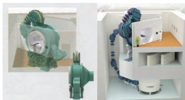
Рис. 12. Однокабинный комплекс компании Sumitomo: компактное гантри типа «штырь» (слева), компоновка комплекса (справа). Ускоритель и гантри размещены на разных уровнях
