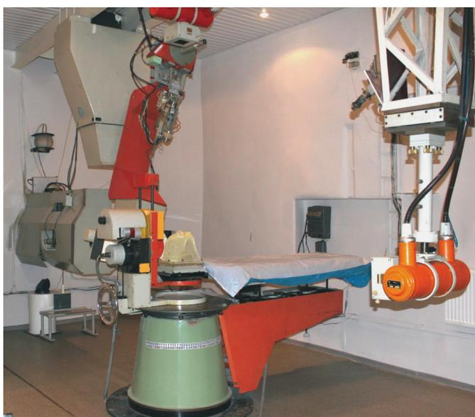
Рис. 2. Центр ПЛТ ИТЭФ. Лучевая установка для облучения внутричерепных злокачественных новообразований на горизонтальном мононаправленном пучке в положении больного лежа
