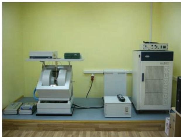
Рис. 3. Общий вид спектрометра ЭПР ELEXSYS E500 фирмы Bruker, применявшегося для проведения исследований
