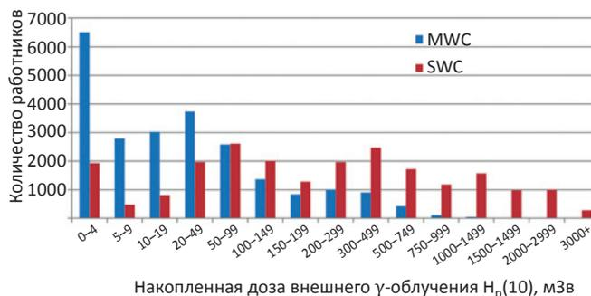
Рис. 2. Распределение количества работников по уровню накопленной дозы внешнего  $\gamma$ -облучения
