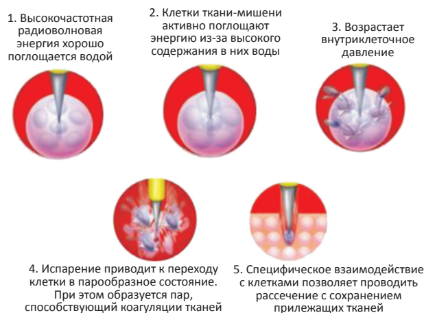
Рис. 1. Принцип работы радиоволновых аппаратов Fig. 1. Principle of operation of radio-wave devices
