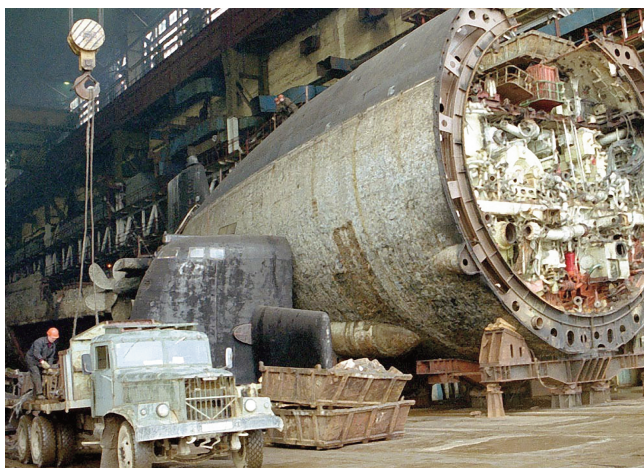
Рис.3 Фрагментация корпуса АПЛ Fig. 3 Fragmentation of the submarine hull
