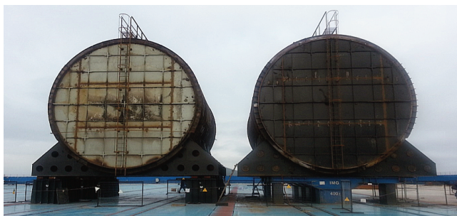
Рис.1. «Сухое» хранение реакторных отсеков АПЛ Fig.1. "Dry" storage of nuclear submarine reactor compartments
