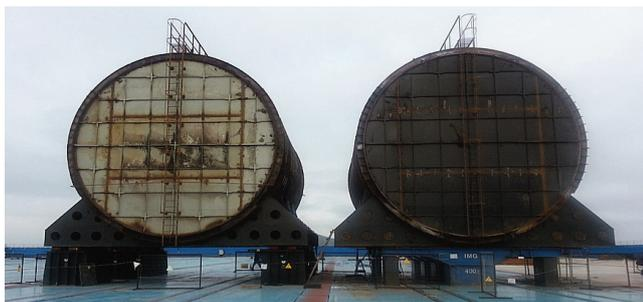
Рис.1. «Сухое» хранение реакторных отсеков АПЛ
