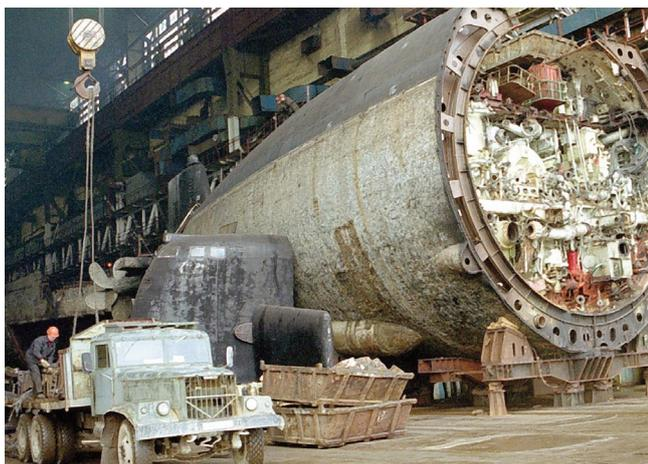
Рис.3 Фрагментация корпуса АПЛ
