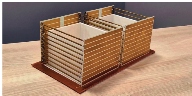
Рис. 2. Фотография метаустройства для исследования молочных желез на МР-томографе с индукцией магнитного поля 1,5 Тл. Fig. 2. Photograph of a metadvice for examining the mammary glands on an MR scanner with 1.5 T magnetic field strength.
