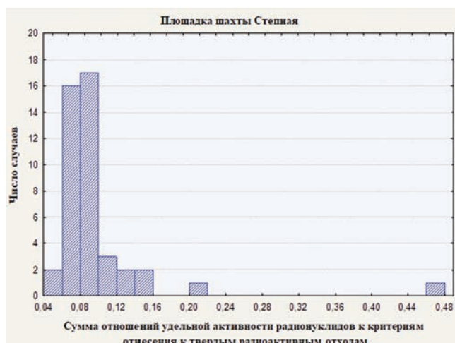
Рис. 8. Распределение суммы отношения удельной активности радионуклидов в почве на площадке шахты к критериям отнесения к твердым радиоактивным отходам
