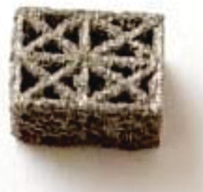
Рис. 3. Внешний вид каркаса источника для брахитерапии
