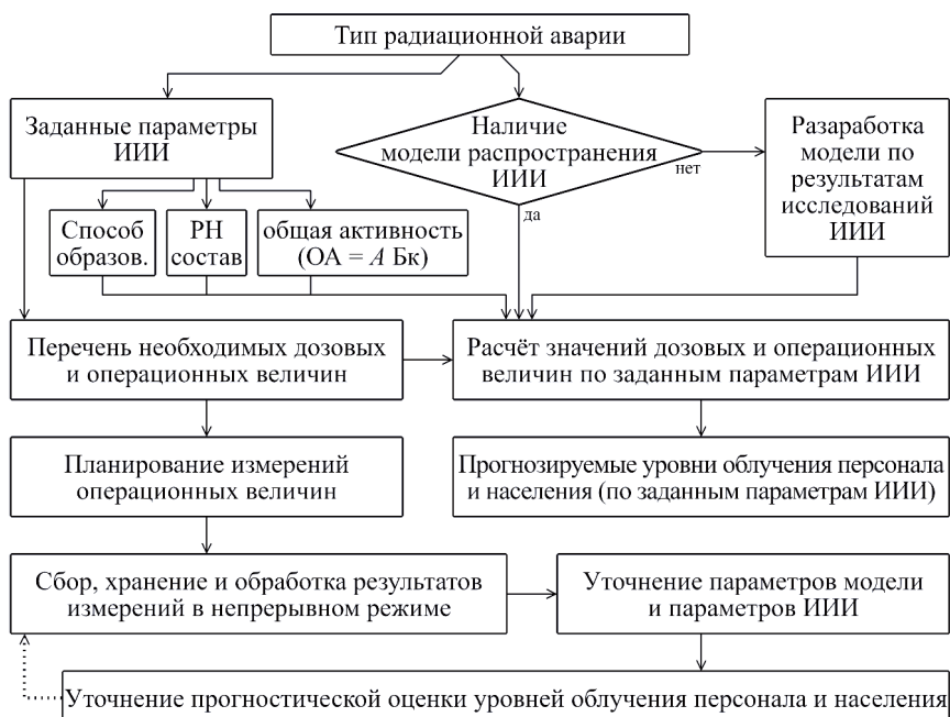
Рис. 4. Алгоритм уточнения расчетных моделей по результатам проведения дозиметрических исследований
