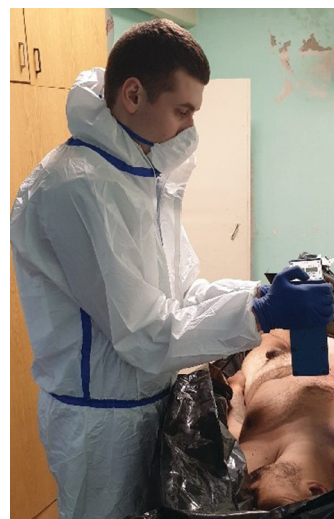
Рис. 1 Рентгеновская съемка «с рук» портативным рентгеновским аппаратом РАП-120М-1Н III
