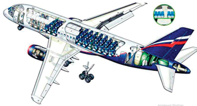
Рис. 3. Схема конструкции кабины и салона пассажирского самолета [42]
